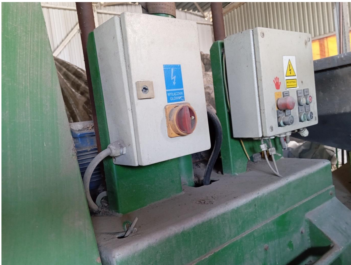
6. Kruszarka do szkła KDS400 - stan urządzenia: blokada bębnow (zapieczone)
