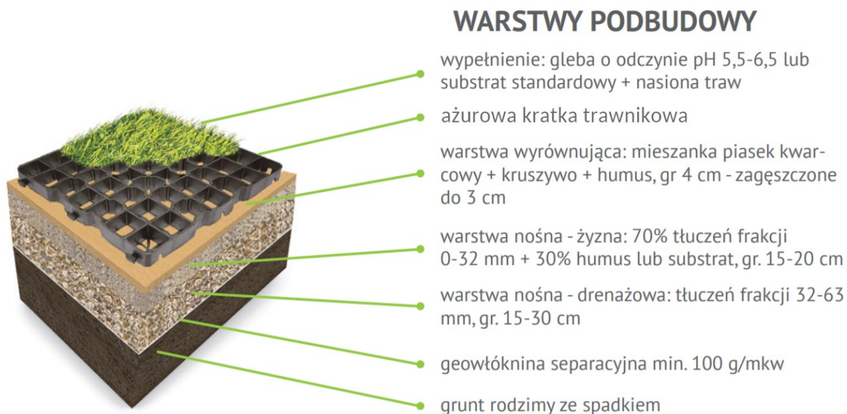
Uszczegółowienie warstw podbudowy – schemat
