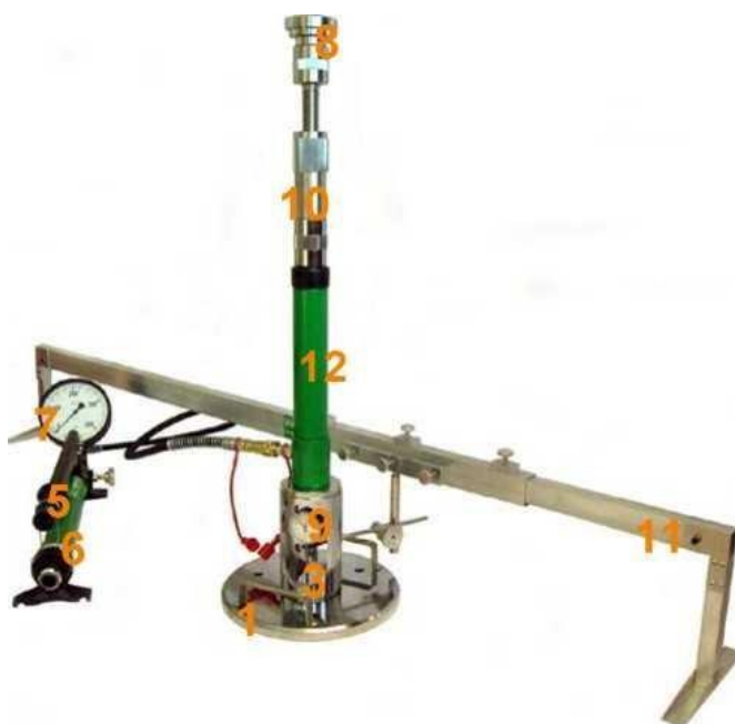
Rys. 1.2 Aparatura VSS z jednopunktowym pomiarem przemieszczenia płyty
