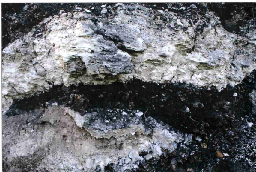
Fot. 3. Odśłonięcie w obwałowaniu Osadnika II (niższy poziom składowania) po stronie skrzyżowania ulic Podmokła-Herberta; widoczne naprzemianległe ułożenie odpadów wapiennych oraz żużla (czerwiec 2007 r.).
