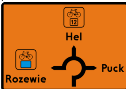
Znak R-4e Tablica przed drogowskazowa szlaku rowerowego. Wymiary zgodnie z rys. 9.10.12. Rozporządzenia.
