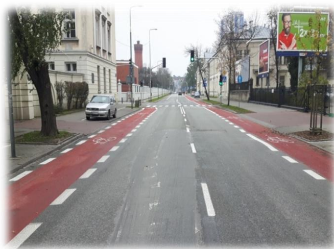
Foto. nr 6. Pasy ruchu dla rowerów (czerwona nawierzchnia) w obszarze zabudowanym. Oznakowanie poziome i oznakowanie poziome.
