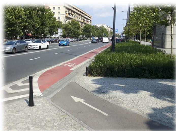
Foto. nr 15. Zjazd z jednokierunkowej drogi dla rowerów na pas ruchu dla rowerów.
