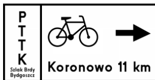
Znak R-3 „tablica szlaku rowerowego lokalnego” wskazuje odległość do głównych miejscowości położonych przy szlaku rowerowym lokalnym (wym. 20,0 cm x 33,0/40,0 cm).
