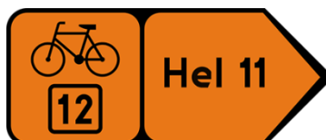
Znak R-4d „drogowskaz tablicowy szlaku rowerowego (wym. 20 cm x długość zgodnie z rys. 9.10.10. Rozporządzenia).
