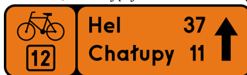
Znak R-4c „drogowskaz tablicowy szlaku rowerowego(wym. 20 cm x długość zgodnie z rys. 9.10.10. Rozporządzenia).
