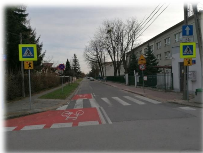
Foto nr 11. Wlot ze skrzyżowania, oznakowanie poziome barwy czerwonej w obrębie skrzyżowania, część jezdni przeznaczoną dla kontra ruchu rowerowego na ulicy jednokierunkowej.
