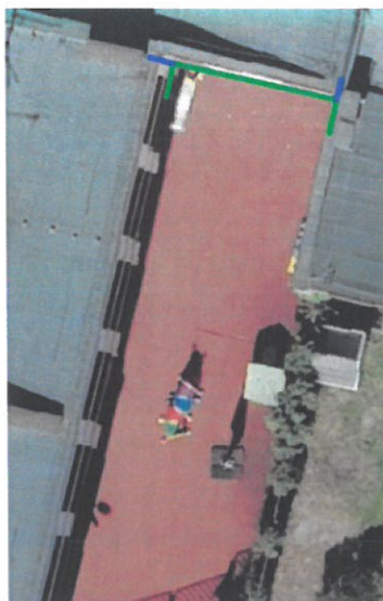
Rys. 13 Zaznaczenie miejsca konieczności wykonania hydroizolacji i ocieplenia ścian piwnicznych budynku przylegających do placu zabaw.
