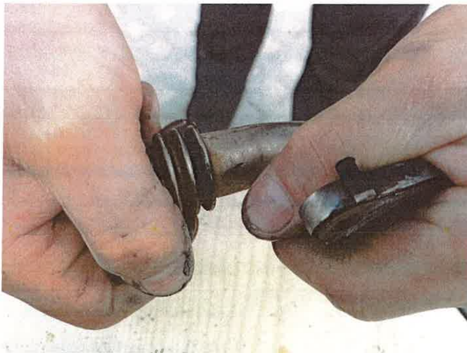
Zdjęcie nr 16. Pęknięta rurka zaworu EGR.
