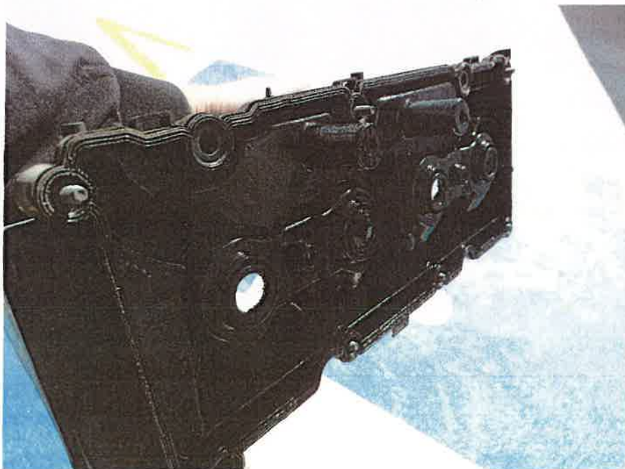
Zdjęcie nr 10. Pokrywa zaworów wybudowana z pojazdu Volkswagen T6 Kombi o numerze rejestracyjnym GDA08124 – widok od dołu – pozostałości po gęstym, przepracowanym oleju silnika.
