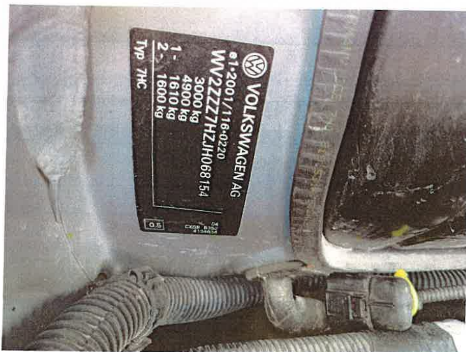
Zdjęcie nr 6. Numer VIN badanego pojazdu znajdujący się na wklejce po prawej stronie komory silnika.
