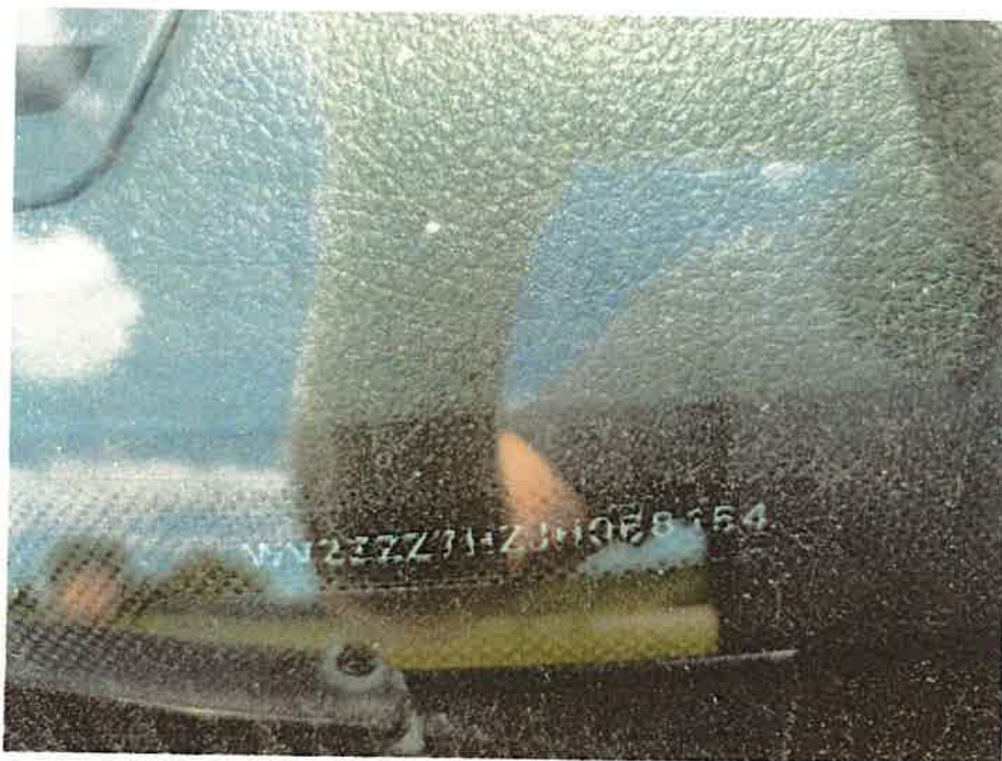
Zdjęcie nr 7. Numer VIN badanego pojazdu znajdujący się pod szybą przednią.
