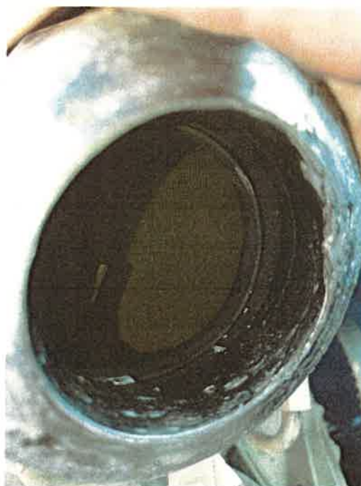
Zdjęcie nr 17. Zapchany wkład filtra cząstek stałych.
