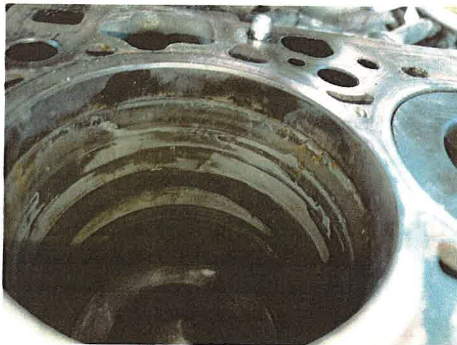
Zdjęcie nr 19. Próg oraz wżery na gładzi 4 cylindra bloku silnika.
