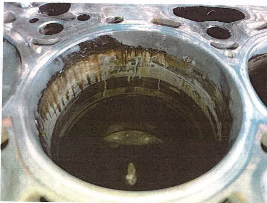
Zdjęcie nr 20. Próg oraz wżery na gładzi 3 cylindra bloku silnika.
