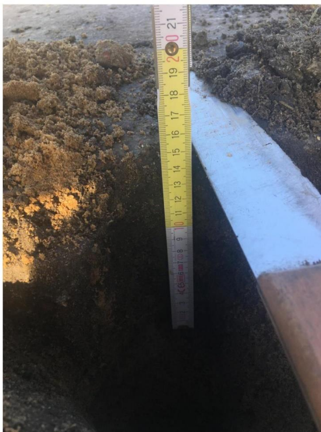
Zdj. 1. Przekrój konstrukcji drogi przy punkcie nr 2.
