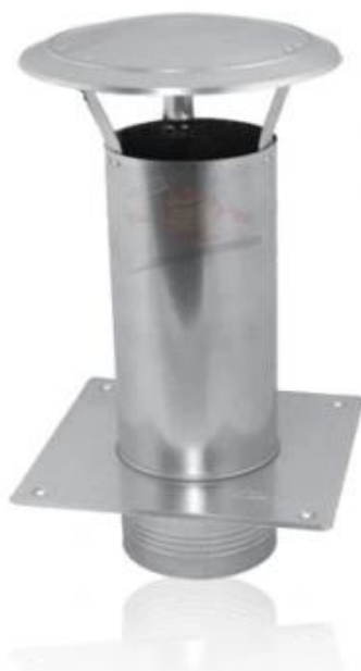
Kominek wentylacyjny o śr. min. 110 mm – materiał: blacha tytan-cynk, stal nierdzewna. Przeznaczona do pokrycia papowego.
