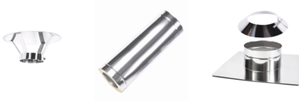
Komin wentylacyjny dwupłaszczowy systemowy o śr. min. 160 mm – materiał: blacha tytan-cynk, stal nierdzewna. Przeznaczona do pokrycia papowego.
