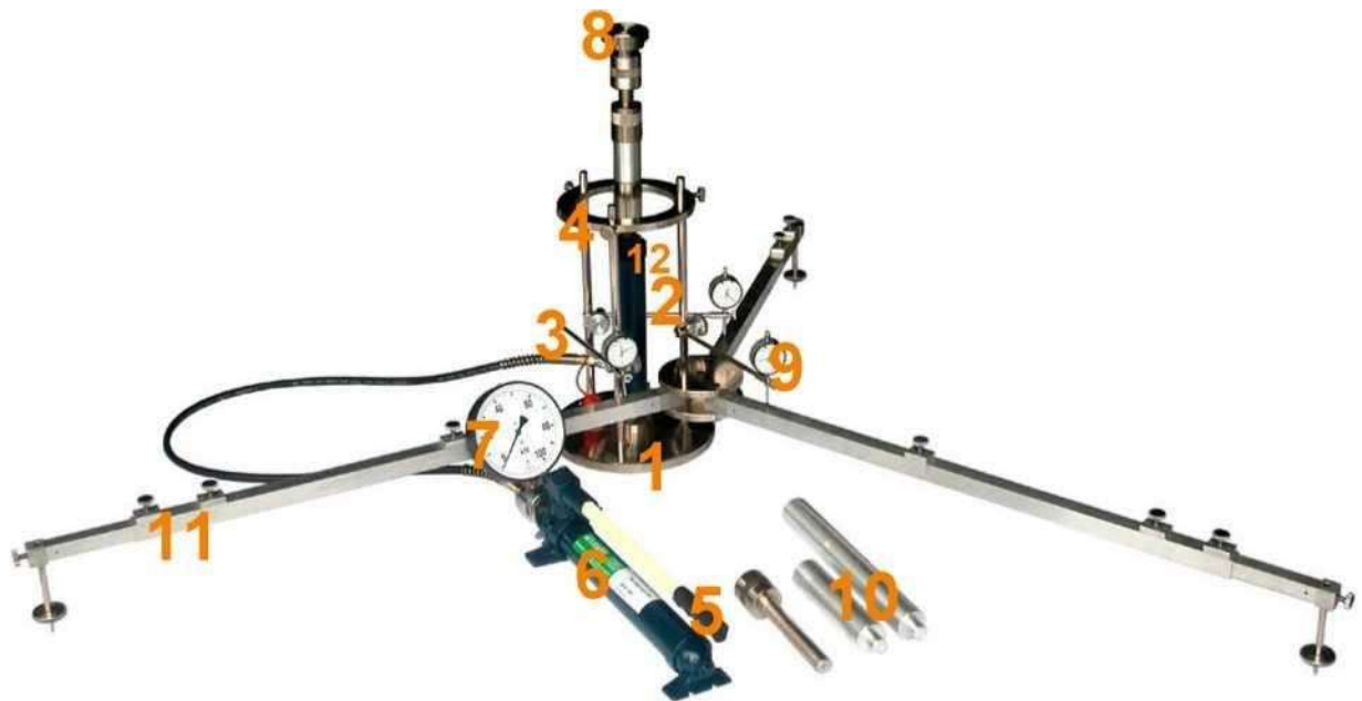
Rys. 1.1. Aparatura VSS z trzypunktowym pomiarem przemieszczenia płyty
