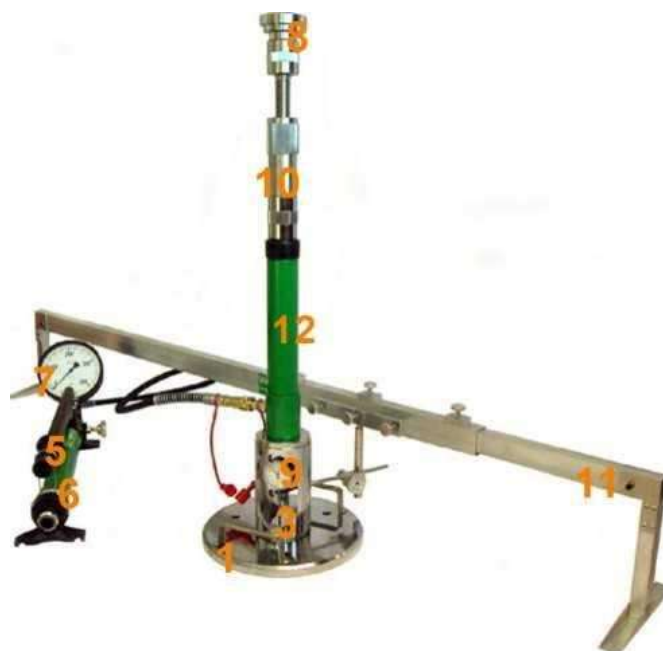
Rys. 1.2 Aparatura VSS z jednopunktowym pomiarem przemieszczenia płyty
