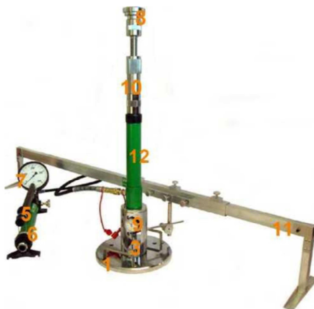
Rys. 1.2 Aparatura VSS z jednopunktowym pomiarem przemieszczenia płyty
