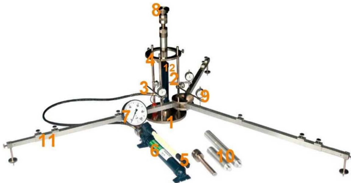
Rys. 1.1. Aparatura VSS z trzypunktowym pomiarem przemieszczenia płyty
