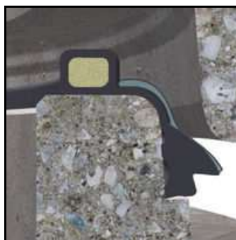
Szkic 1: Uszczelka samosmarująca z kompensatorem naprężeń
