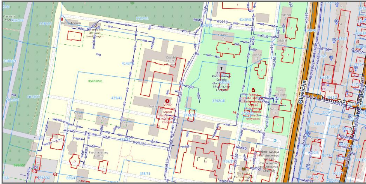
Rys. 4. Plan sytuacyjny przebiegu instalacji zimnej wody
