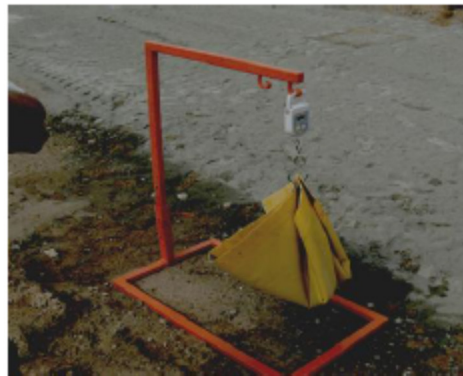
Ważenie tacki pomiarowej ze spoiwem
