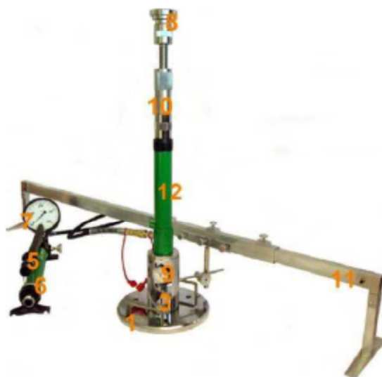
Rys. 1.2 Aparatura VSS z jednopunktowym pomiarem przemieszczenia płyty
