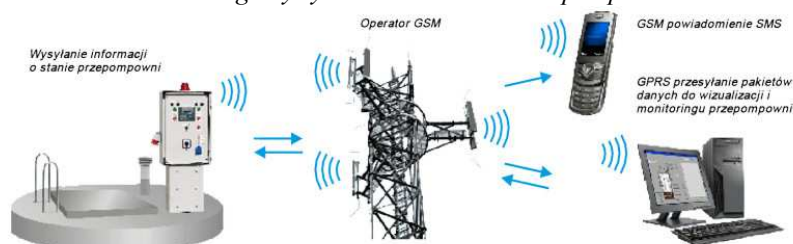
Schemat ogólny systemu monitorowania pompowni
