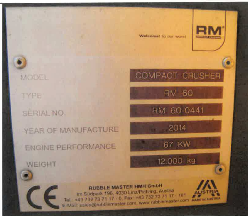
Fot. 17. Tabliczka znamionowa wraz ze znakiem zgodności CE widoczny na tabliczce znamionowej kruszarki udarowej
